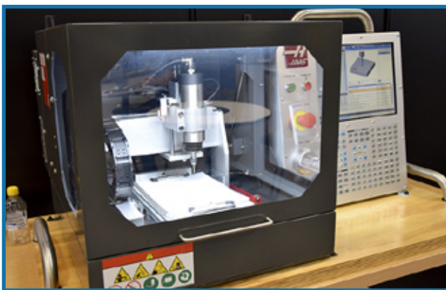
Pieni ja kompakti. Haasin Desktop Mill on nimensä mukaisesti kompaktin kokoinen ja siten myös nasevasti messuilla esiteltävä pöytäjyrsinkone esimerkiksi koulutuskäyttöön oppilaitoksissa tai muuten vain alan harrastajille. Kolme akselia, karassa kierroksia max. 15 000 1/min, Haas-ohjaus.
