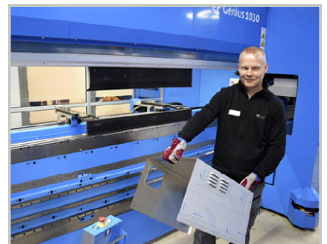
Uutta Prima Powerin särmäysteknologiaa edusti teknologiakeskuksen demoissa eP Genius 1030. Jani Sillanpää taivutti mikroalutouunin kotelorakennetta.
