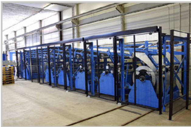
Kelalinjat ovat yksi Vaskin keskeinen ja markkinoilla menestyvä tuotesektori. Levytyökeskukseen liitettävä, layoutiltaan ja rakenteeltaan osalta uudistunut materiaalinvaihdon osalta täysautomaattinen linja kuudella kelalla oli esittelyssä.
