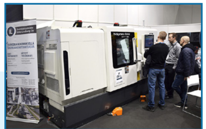
Isojoen Laitevalmisteen uutuus messuesittelyssä, Fincut Drillinger on uusi levyleikkeiden porauskeskus, mihin on yhdistetty myös viisteplasma taakse. Kara liikkuu myös pöydän ulkopuolelle, jolloin reiät ja kierteet onnistuvat myös reunoihin tai pyöröakselien päihin. Innovatiivinen pöytä mahdollistaa kätevät kiinnitykset.
