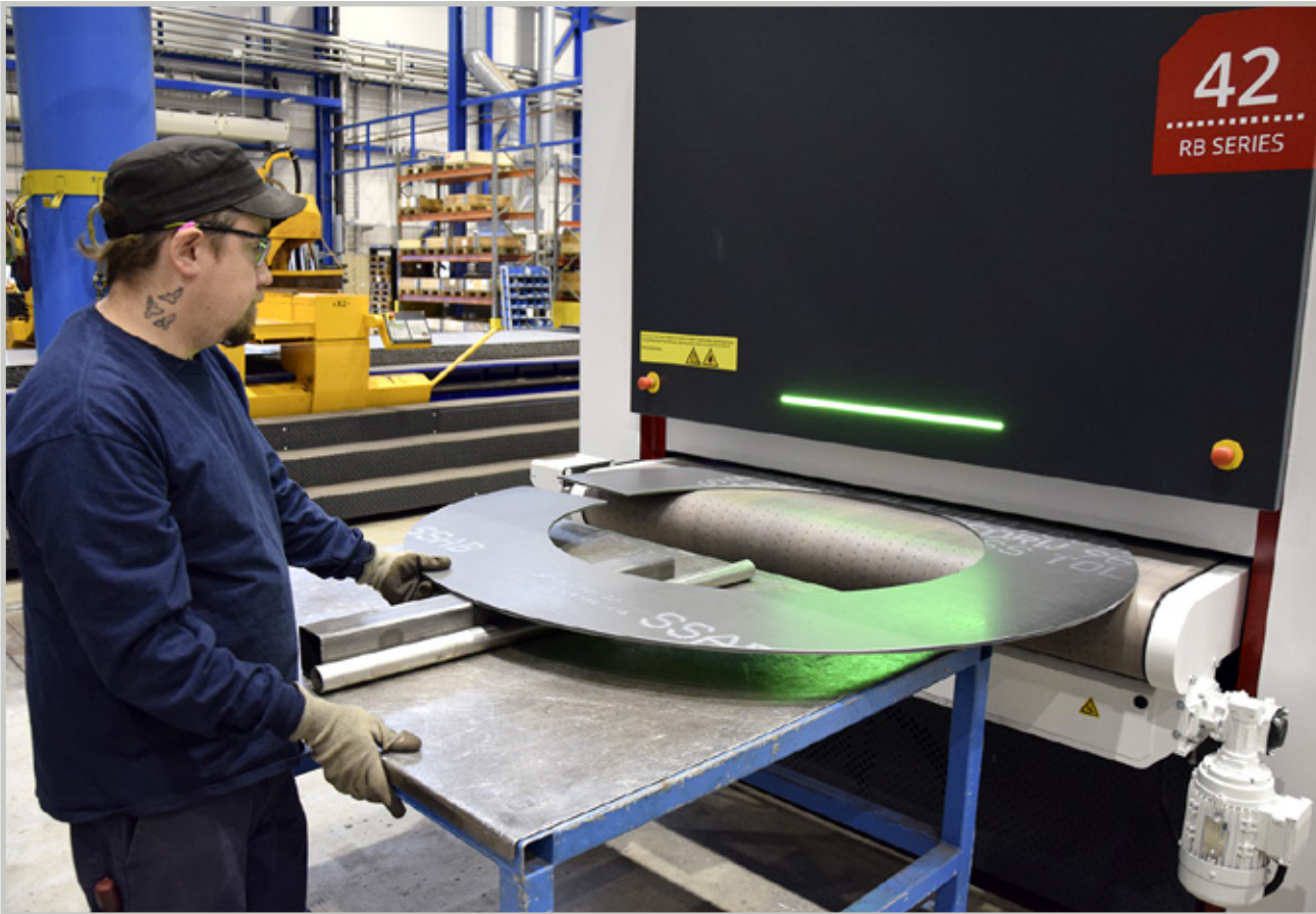
Koneella voidaan käsitellä kappaleita 1600 mm leveyksiin saakka. Puhaltimen kehä käsittelyssä, operaattorina Ville Haapalehto.
