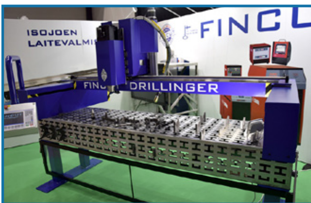
Isojoen Laitevalmisteen uutuus messuesittelyssä, Fincut Drillinger on uusi levyleikkeiden porauskeskus, mihin on yhdistetty myös viisteplasma taakse. Kara liikkuu myös pöydän ulkopuolelle, jolloin reiät ja kierteet onnistuvat myös reunoihin tai pyöröakselien päihin. Innovatiivinen pöytä mahdollistaa kätevät kiinnitykset.
