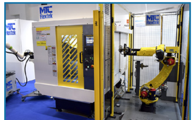
MTC Flextekin osastolla oli mukana runsaasti tarjontaa eri tuote- ja palvelualueelle. Kuvassa koneista RoboDrill malliston suurin Robodrill eli malli alpha-D21LiB5 Plus. RoboDrill-koneita on saatavilla eri karan teho- ja nopeusvaihtoehdoilla 3-, 4- tai 5-akselisina, automatisointi saman valmistajan roboteilla on saatavilla.
