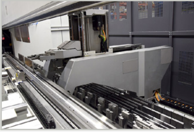
Koneessa rakenteeseen kuuluva sormityyppinen työkalunvaihtaja vaihtaa ylä- ja alatyökalut automaattisesti koneen rungon sisään integroidusta työkaluvarastosta.
