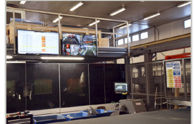
Kamerajärjestelmän myötä leikkausta ja järjestelmän toimintaa voidaan seurata screenilta. Oma järjestelmä mahdollistaa tuotannon seurantaan liittyvät toiminnot.
