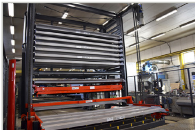
Automaatiolla voidaan käsitellä levyjä 25 mm vahvuuksiin saakka, laser leikkaa jopa 50 mm vahvuuksia. Tornivaraston palettien kapasiteetti on 5 tonnia.
