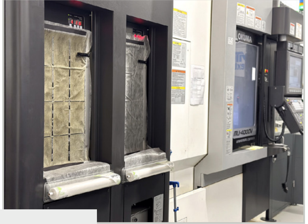
Velum-suojasuodattimet suojaavat työstökoneiden sähkömoottoreita öljysumulta ja pölyltä.
