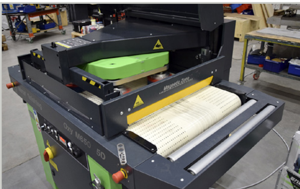
Työleveyttä Oxyssa on 650 mm ja koneella voidaan käsitellä kappaleita aina 0,5 mm:stä 150 mm vahvuksiin saakka. Nopeus- ja korkeussäädöt käyvät etuosan paneelista.
